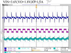
Soft Start(CH1:VIN, CH2:VO, CH3:VSW,CH4:ISW)
