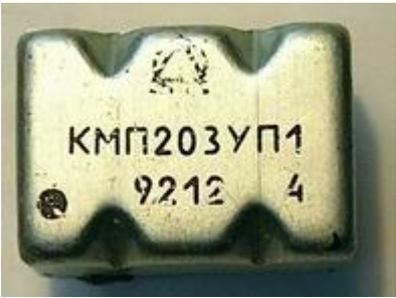
В процессе ремонта стрелочных тестеров Ц4342, Ц4352, Ц4353, Ц4354, Ц43101 часто выходит из строя микросборка защиты головки. Поиск таких сборок успехом не увенчался, поэтому пришлось изготовить аналог на дискретных элементах. Ниже схема включения микросборок и принципиальная схема их аналога. Идея защиты взята из прибора Ц4317.
